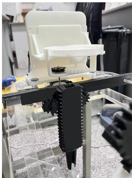
图 2.4.2.1 分苗插苗装置实物图
