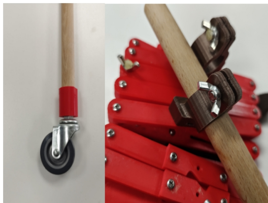
图2-5 残疾宠物辅助支架腿部万向轮装置细节图
